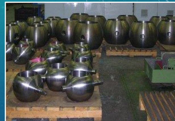
Защита от износа и коррозии деталей запорной арматуры (агрессивная среда и абразивное воздействие)
