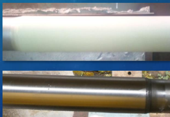
Гребные валы с покрытием бронза 1.5 мм и сталь X18H9 4.5 мм
