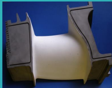
Направляющая лопатка 2 ступени газовой турбины SGT-800 Siemens (теплозащитное покрытие ZrO 2 )
