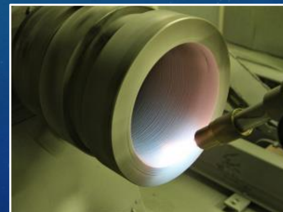
Восстановление баббитового слоя в подшипниках и вкладышах скольжения
