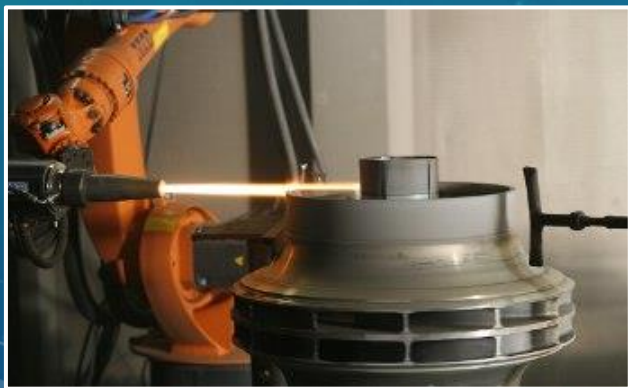
Защита от кавитации рабочих колёс центробежных насосов
